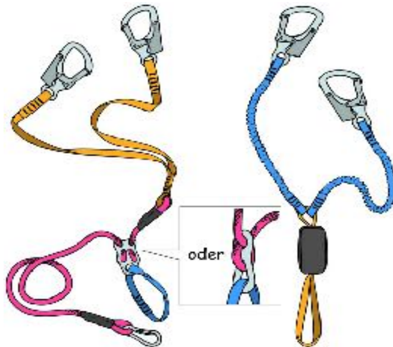
Rope-friction based via ferrata set (Source: Deutscher Alpenverein DAV)
